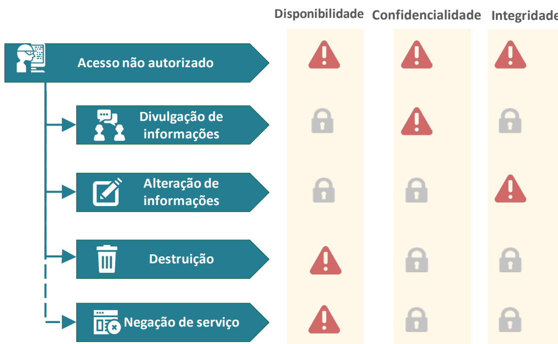
Figura 1 – Tipos de ameaças e princípios de segurança que estas colocam em risco
